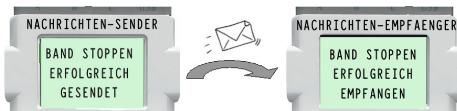
Abbildung 2: LCD-Ausgaben beim Versand/Empfang von Bluetooth Nachrichten
