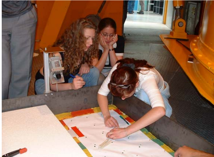
Messung der Abstände der Einschlaglöcher zu den vorher eingezeichneten Punkten
